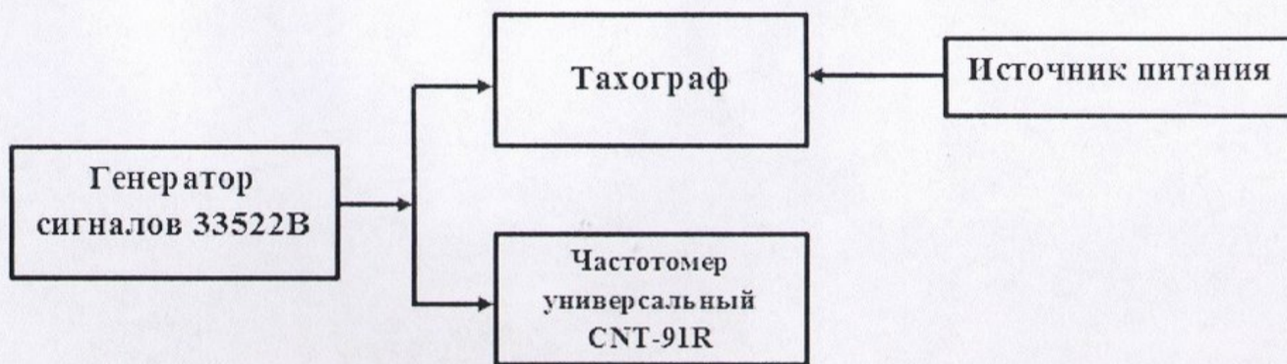
Рисунок 2 – Схема проведения измерений при определении погрешности измерения интервала времени и инструментальной погрешности пройденного пути
